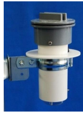
強制通風式温度計
